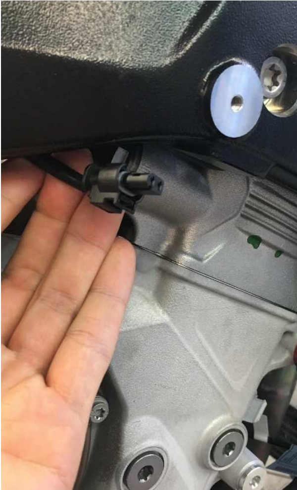
Image 15: Connecteur à 2 broches sous la poutre du châssis principal.
