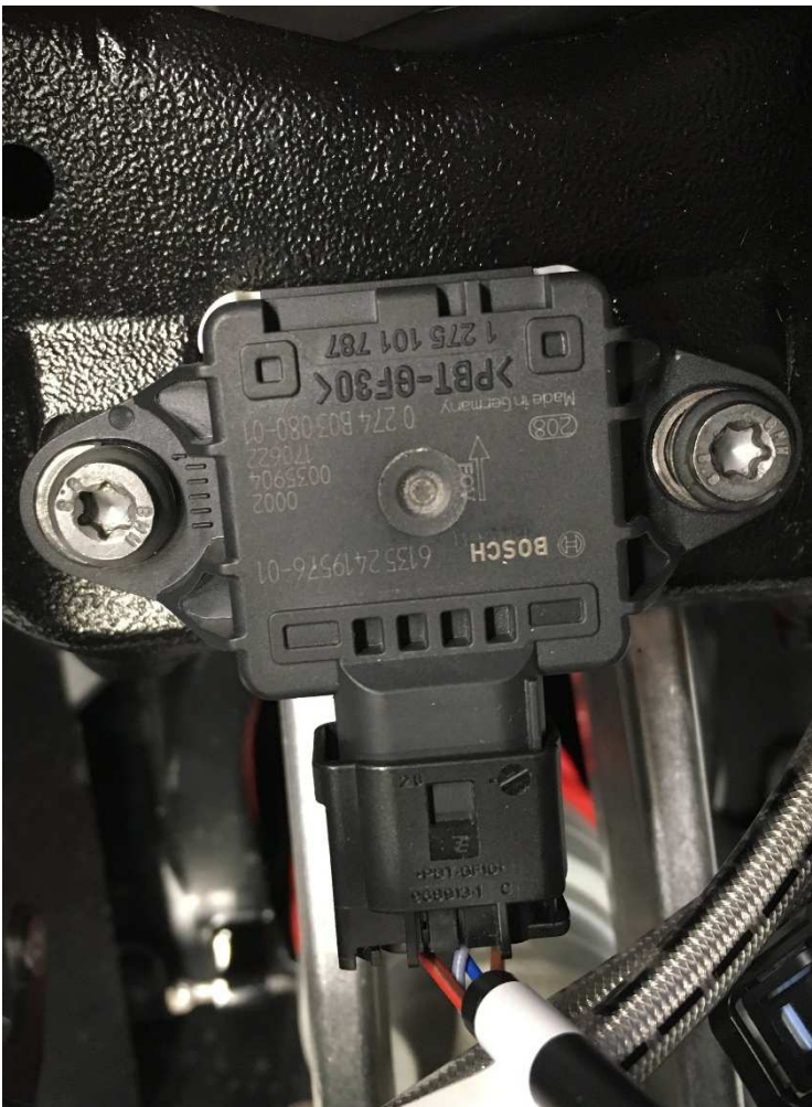
Image 31: Capteur d'angle d'inclinaison orienté vers l'arrière de la moto.
