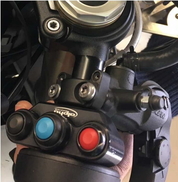
Image 26: Commodo droit entre la poignée de gaz et le maître-cylindre de frein.
