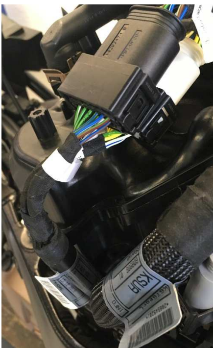
Image 5: Faisceau moteur supérieur et inférieur à droite de la boîte à air.
