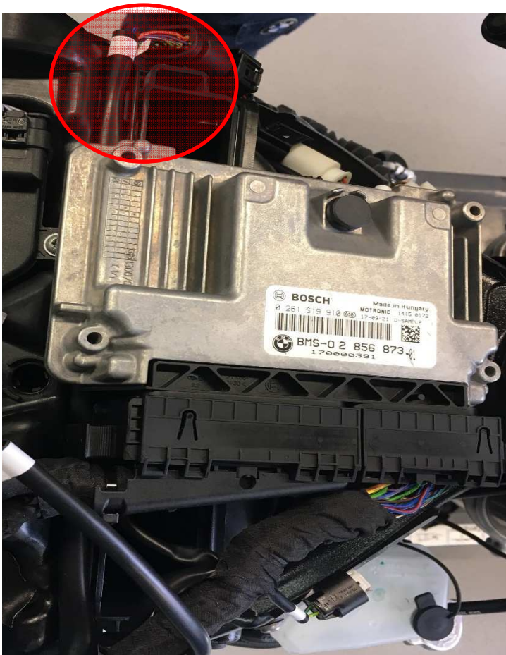
Image 6: Faisceau supérieur sur le dessus de la boîte à air.
