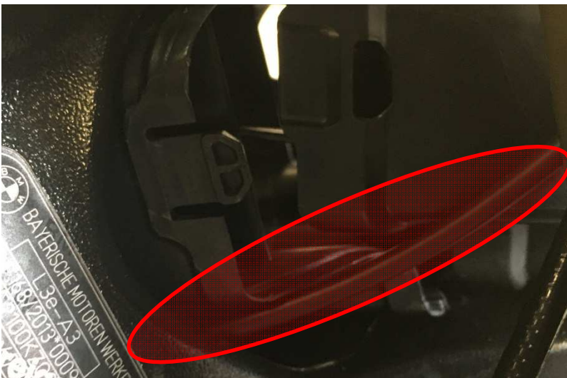
Image 24: Cordon de la poignée de gaz passant à travers le cadre à droite du conduit d'entrée d'air.
