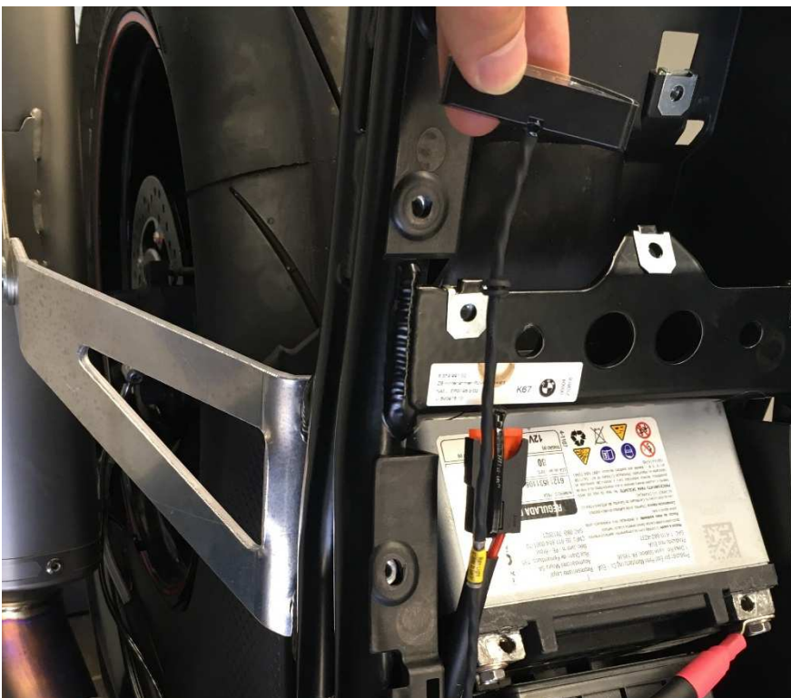
Image 20: Feux arrière de pluie et fusible principal.
