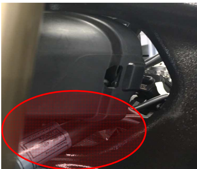
Image 22: Vue détaillée du guidage du faisceau avant à travers le cadre principal.
