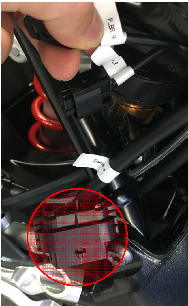
Image 18: Connecteur du capteur de frein arrière et prise diagnostique
