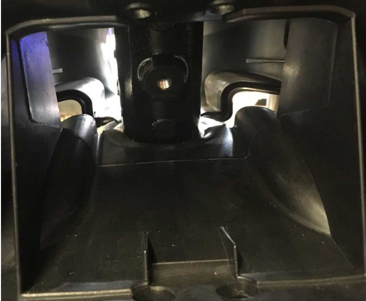
Image 1: Conduit d'air d'admission sans volet d'air.
