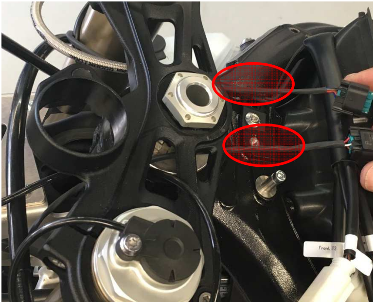
Image 28: Cordons des commodos et leurs possibles passages
