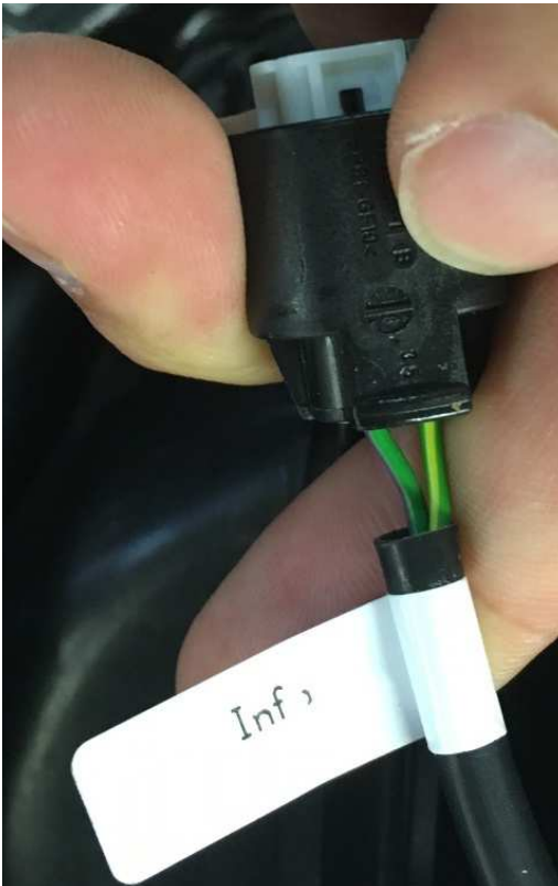
Image 30: Connecteur info proche de l'ECU.
