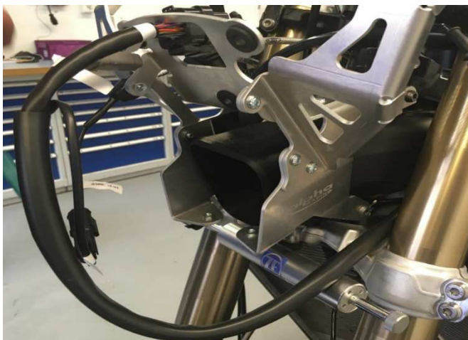
Image 21: Faisceau tête de fourche à gauche du conduit
