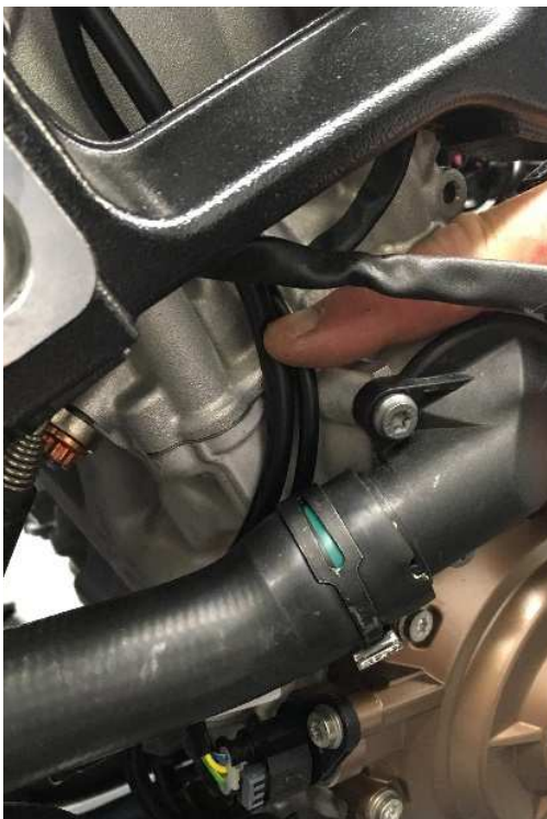
Image 10: Fils éloignés du collecteur d'échappement.
